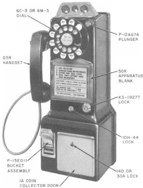
Fig. 3—236G Coin Collector
